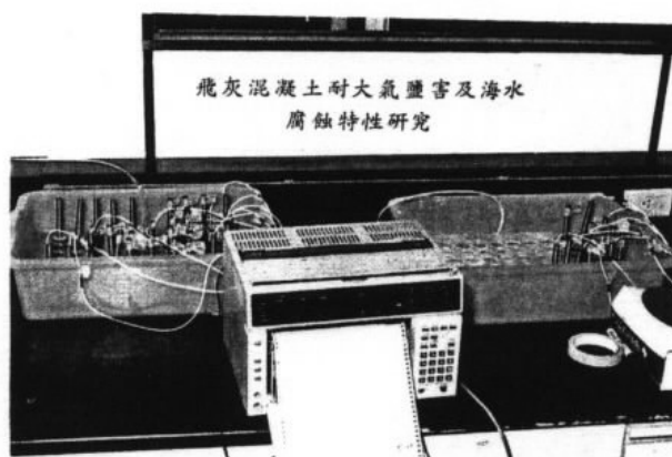
照片7 含飛灰混凝土鋼筋腐蝕研究
