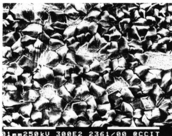
圖 3(c) 鋼材經磷酸鹽處理 10 分鐘後，表面晶粒集結情形。
