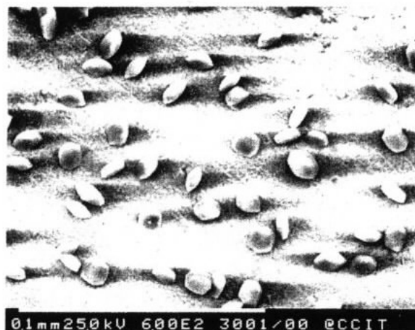
圖 3(b) 鋼材經磷酸鹽處理 2 分鐘後，表面晶粒成長圖。
