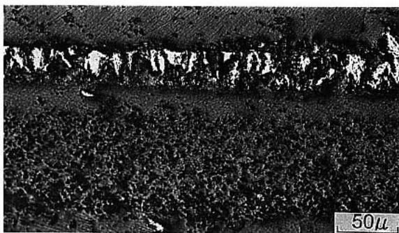
圖 5 SCH-11於900°C氯氫氣氛高溫腐蝕24小時之截面金相。
