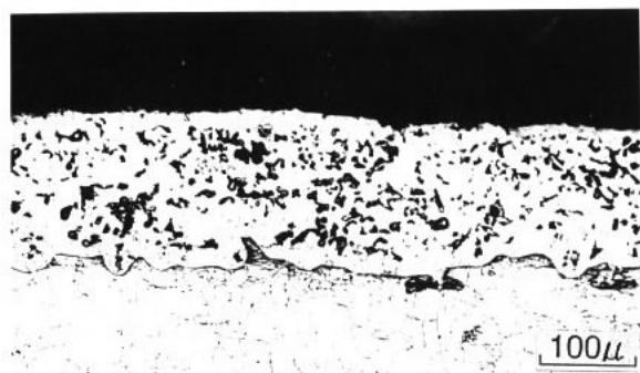
圖 3 3Cr合金於900°C CPVC熱分解氣氛高溫腐蝕 8 小時之截面金相。
