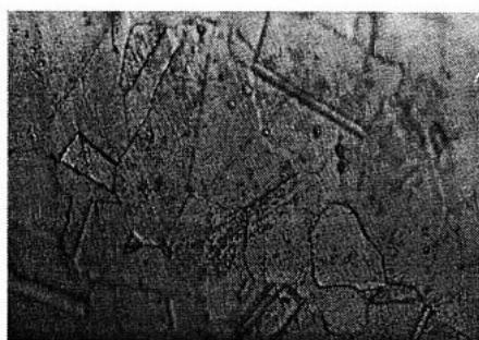
圖 10 草酸腐蝕 304 不銹鋼(空冷)母材金相組織(500X)
