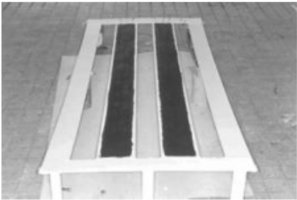
圖 6. 導電塗料防污裝置完成後之外觀。
