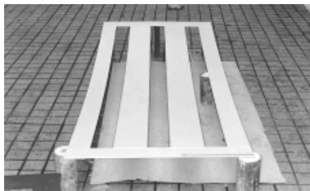
圖 3 絕緣塗料處理後之試驗架外觀。
