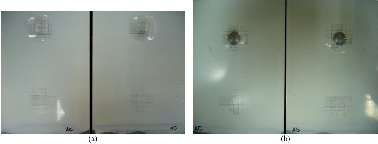
圖 2 方格及方格+艾氏試驗結果。(a) 無鉻試片；(b) 鉻酸試片。
